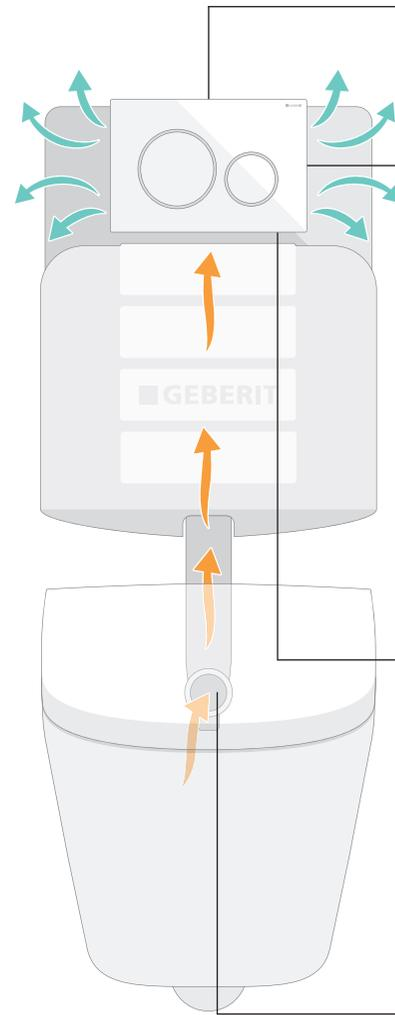
Keramikwabenfilter und Einschub für Spülkastenstick sind hinter der Betätigungsplatte bequem zugänglich.
