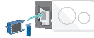
Im Keramikwabenfilter wird die Luft gründlich gereinigt. Ein leiser Lüfter befördert die gereinigte Luft in den Raum zurück.
