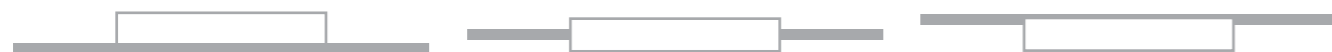
↑ Umivalniki Geberit VariForm nudijo vse možnosti: lahko so nadpultni, vgradni ali podpultni.
