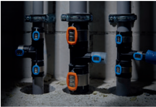
OPAZEN INDIKATOR STISKANJA Tudi pri slabi vidnosti je še vedno mogoče videti, ali je indikator stiskanja še vedno na fittingu ali pa je povezava že stisnjena.
