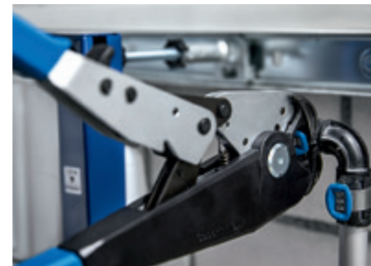
Ročne klešče za stiskanje pokrivajo pet dimenzij in ne zahtevajo električnega toka ali polnilnih baterij.
