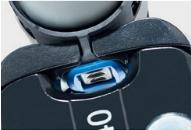
OBLIKA KOT VODILO ZA NAMEŠČANJE ORODJA Orodje in indikator stiskanja sta kot ključ in ključavnica. To tako rekoč odpravi nevarnost napačnega stiskanja, ki bi bilo posledica namestitve orodja na nepravo mesto.
